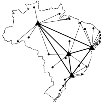
Figura 32 – Exemplo de uma rede do tipo E-R com alocação múltipla
