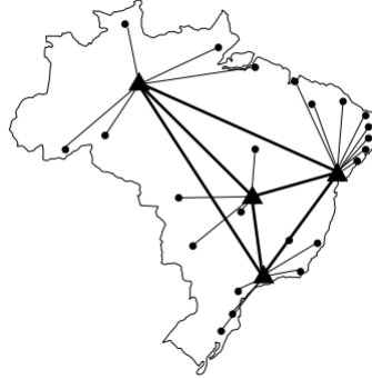
Figura 22 – Exemplo de uma rede do tipo E-R com alocação simples
