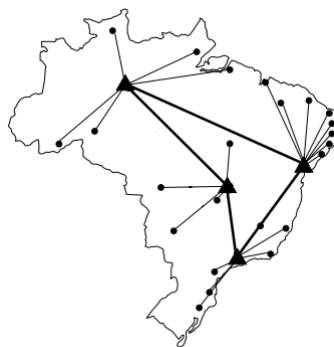
Figura 41 – Exemplo de uma rede do tipo E-R com alocação simples e concentradores ligados em anel
