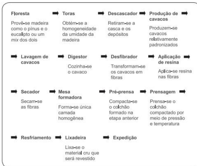
Figura 20: A fabricação do MDF.
