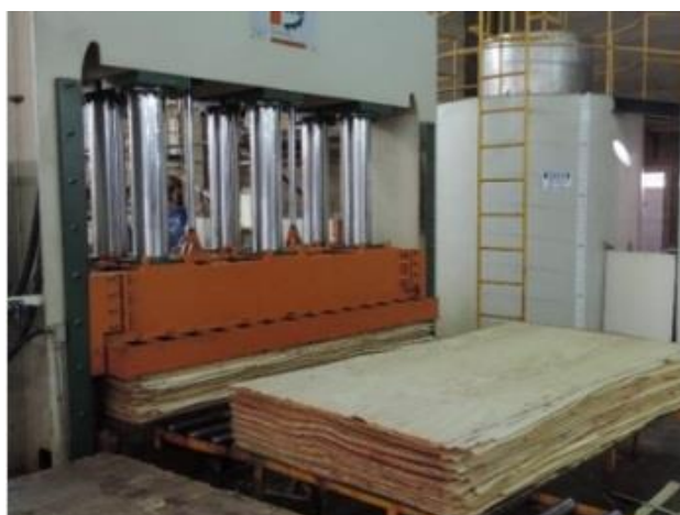
Figura 14: Pré- prensagem de compensado a frio
