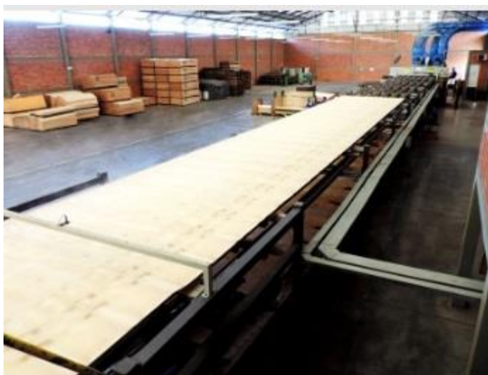
Figura 10: Lâmina proveniente da tora seguindo para o corte.
