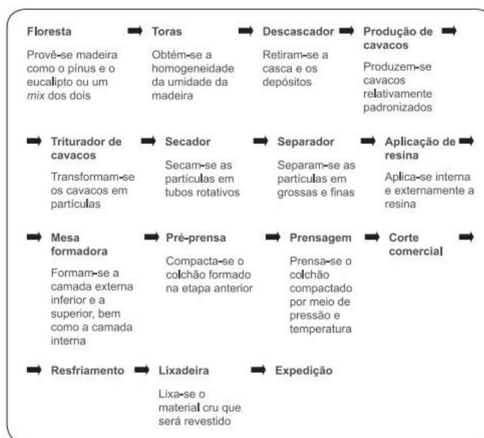
Figura 19: A fabricação do MDP.
