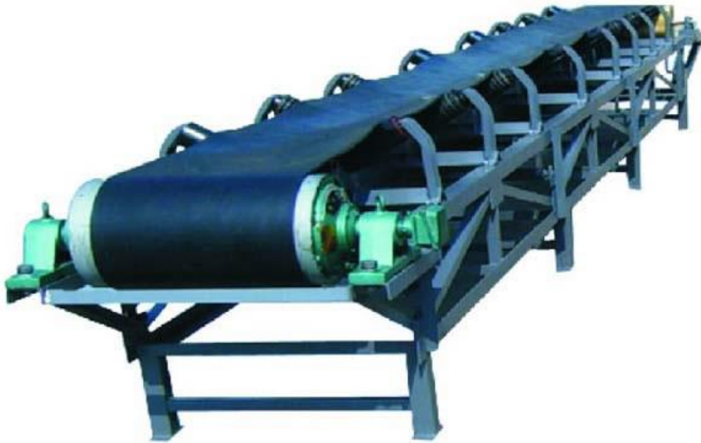
Figura 7 - Exemplo de Correia Transportadora com as mesmas características de transporte de minério correspondente ao processo em análise. Fonte: http://ore-beneficiation.com.br/ , 20165
