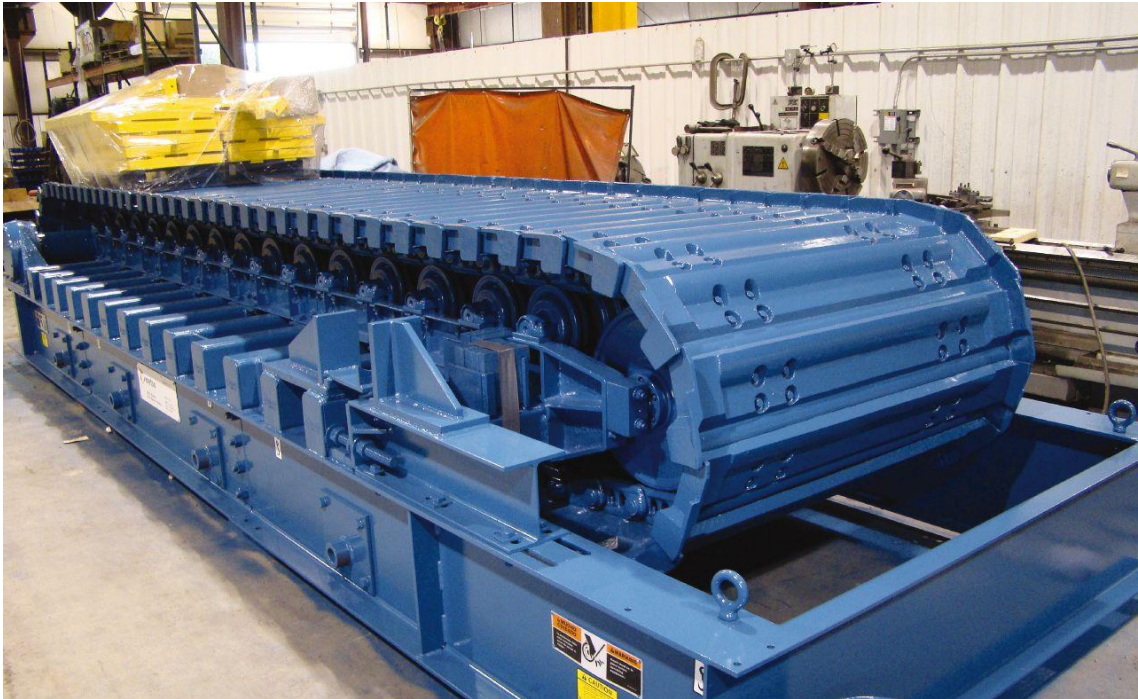
Figura 4 - Exemplo de Alimentador de Sapatas com as mesmas características do equipamento sob estudo nesse trabalho. Fonte: WWW.METSO.COM.BR, 2016 2
