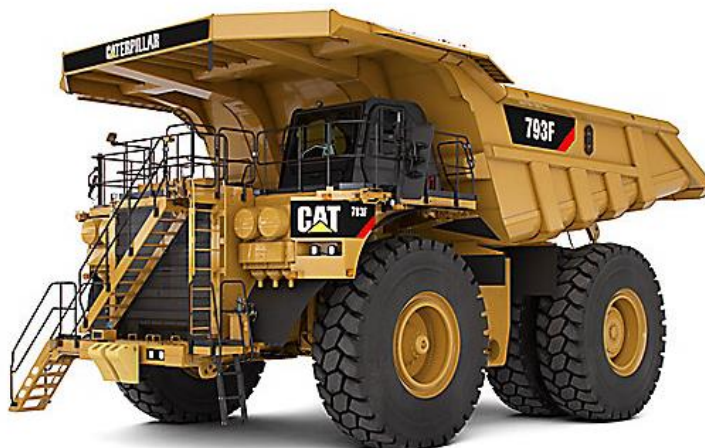
Figura 2 - Caminhão fora de estrada modelo 793F, utilizado no processo de transporte de carga. Fonte: WWW.CAT.COM, 2016 1
