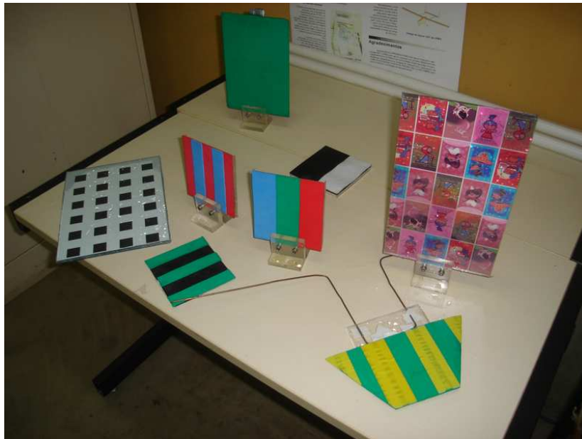
Figura 4.11. Objetos utilizados nos experimentos. Foram utilizados objetos de geometria simplificada e cores variadas. Na imagem podem ser vistos os objetos utilizados para a montagem das cenas e os usados na calibração do setup.
