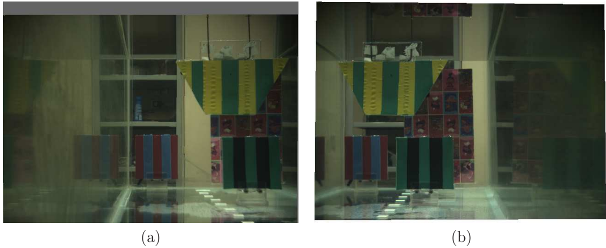
Figura 4.16. As imagens, retificadas, obtidas com a câmera à esquerda (a) e direita (b) para baixa turbidez já apresentam problemas para a etapa de correspondência. Reflexos e um tom esverdeado devem-se ao vidro de aquário e efeitos da água.
