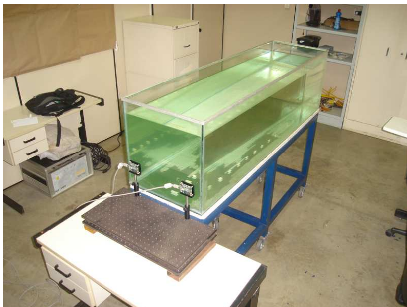
Figura 4.12. Setup experimental para cenas reais. Foram utilizados um aquário possui dimensões de 168 x 47 x 45 cm e duas câmeras Dragon Fly geometricamente calibradas separadas de 33 cm em disposição fronto-paralela.
