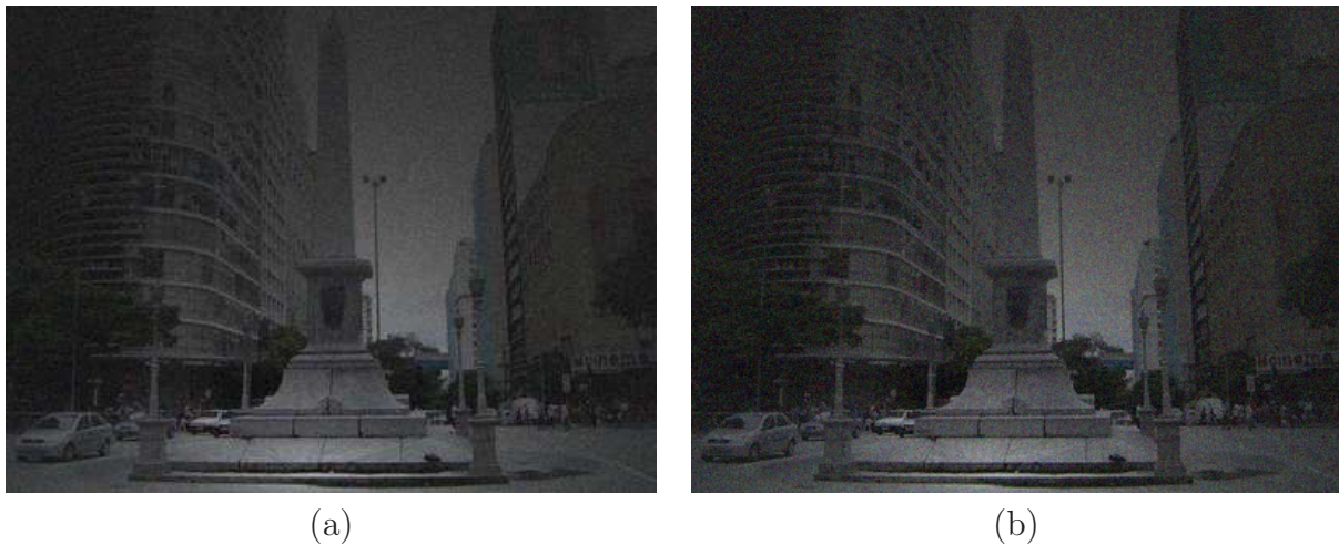
Figura 4.4. A degradação causada por um ruído gaussiano de média zero em (a) \sigma = 0,001 e em (b) \sigma = 0,002 corrompe sensivelmente a qualidade das imagens simuladas.
