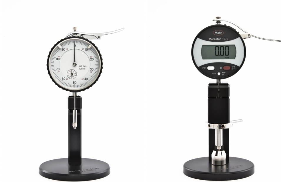
Figura 3 – Micrômetro (painel da esquerda) e testador de dureza (painel da direita) para seleção das canas.
