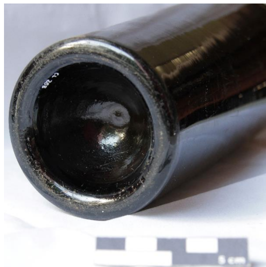
FIGURA 111 - Garrafa preta de vinho, feita pelo sopro rotativo em molde. Observar as finas linhas horizontais no corpo da garrafa Fonte: Sarah Hissa, 2019.
