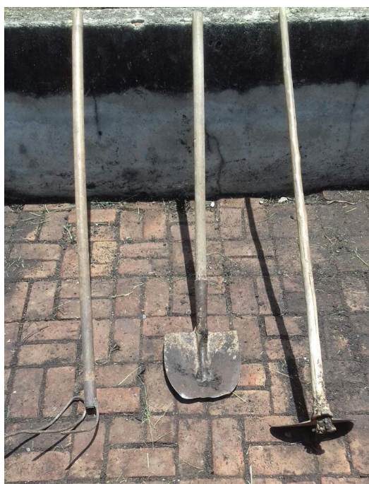
Figura 4.12 – Ferramentas utilizadas para reviramento do material
