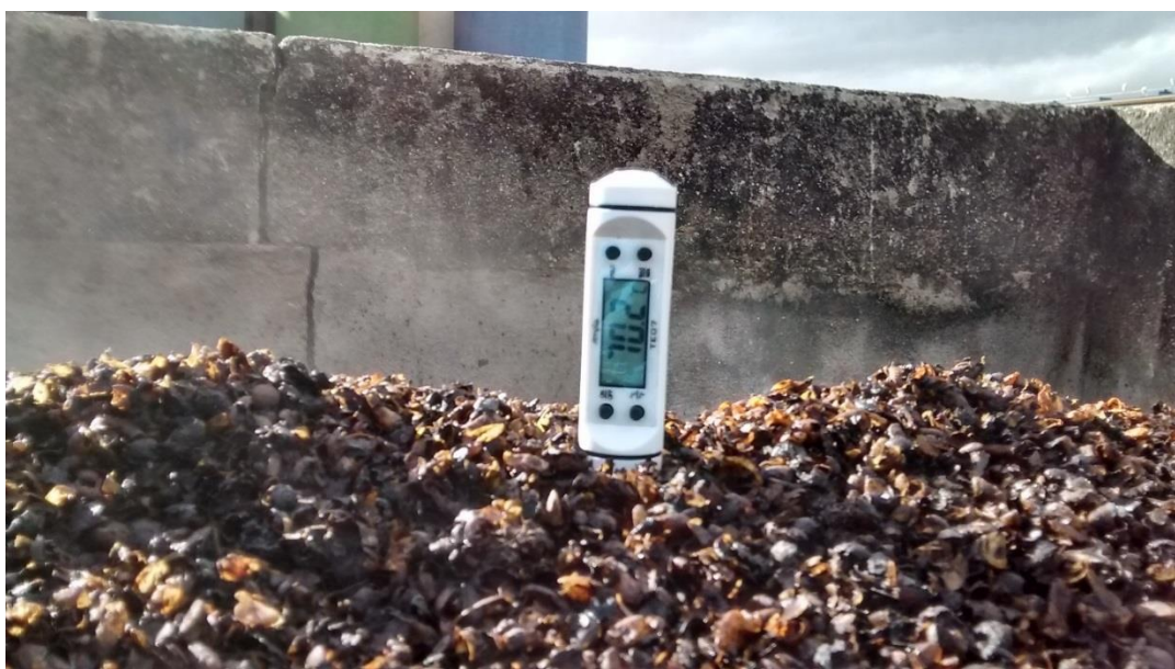
Figura 4.14 – Exemplo da medição de temperatura do material das pilhas
