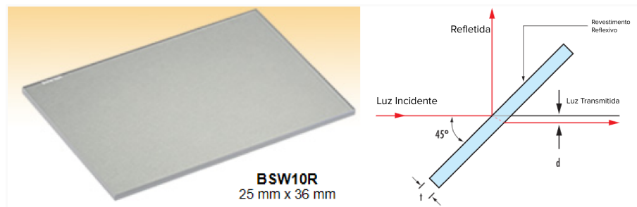
Figura 25 – (Esquerda) BSP utilizado na montagem. (Direita) Diagrama indicando o funcionamento do BSP. Adaptado de [42]
