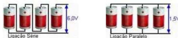
Figura 06. Esquema de associação de pilhas em série e em paralelo. Fonte: Filho (2011).
