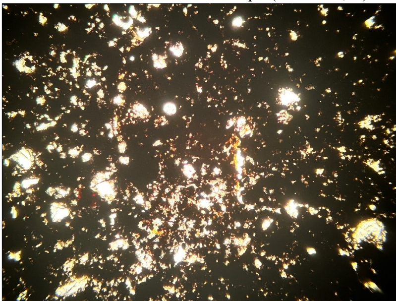
Figura 46 – Fotomicrografia do horizonte C 2 do perfil 6 com trama escurecida devido ao grande acúmulo de material orgânico e menor presença de material grosso em relação à micromassa escurecida em destaque (aumento 2,5x)
