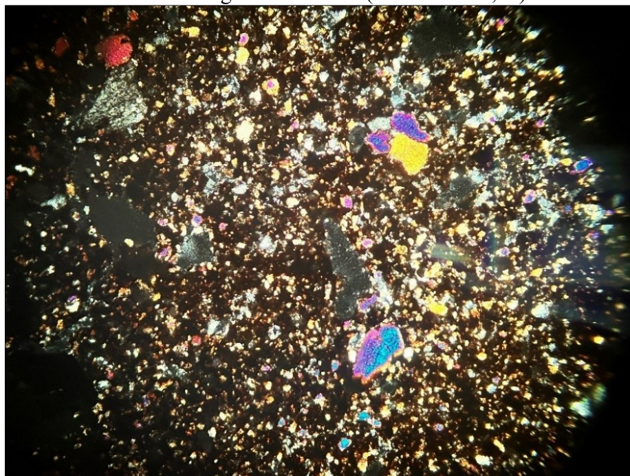
Figura 33 – Visão da lâmina do horizonte 2C 2 sob nicóis cruzados, destacando a distribuição do material grosso na trama (aumento de 2,5x)
