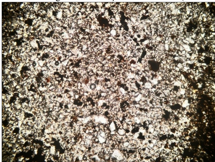
Figura 42 – Fotomicrografia do horizonte 3C 1 destacando sua trama enáulica com muita frequência de material grosso em relação à micromassa (aumento de 2,5x)
