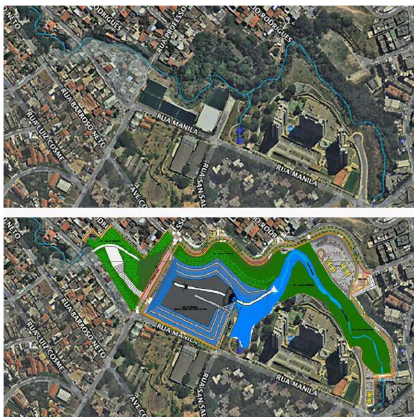
Figura 57: Vista aérea e fotomontagem com estudo da bacia de retenção para implantação no córrego do Cercadinho
