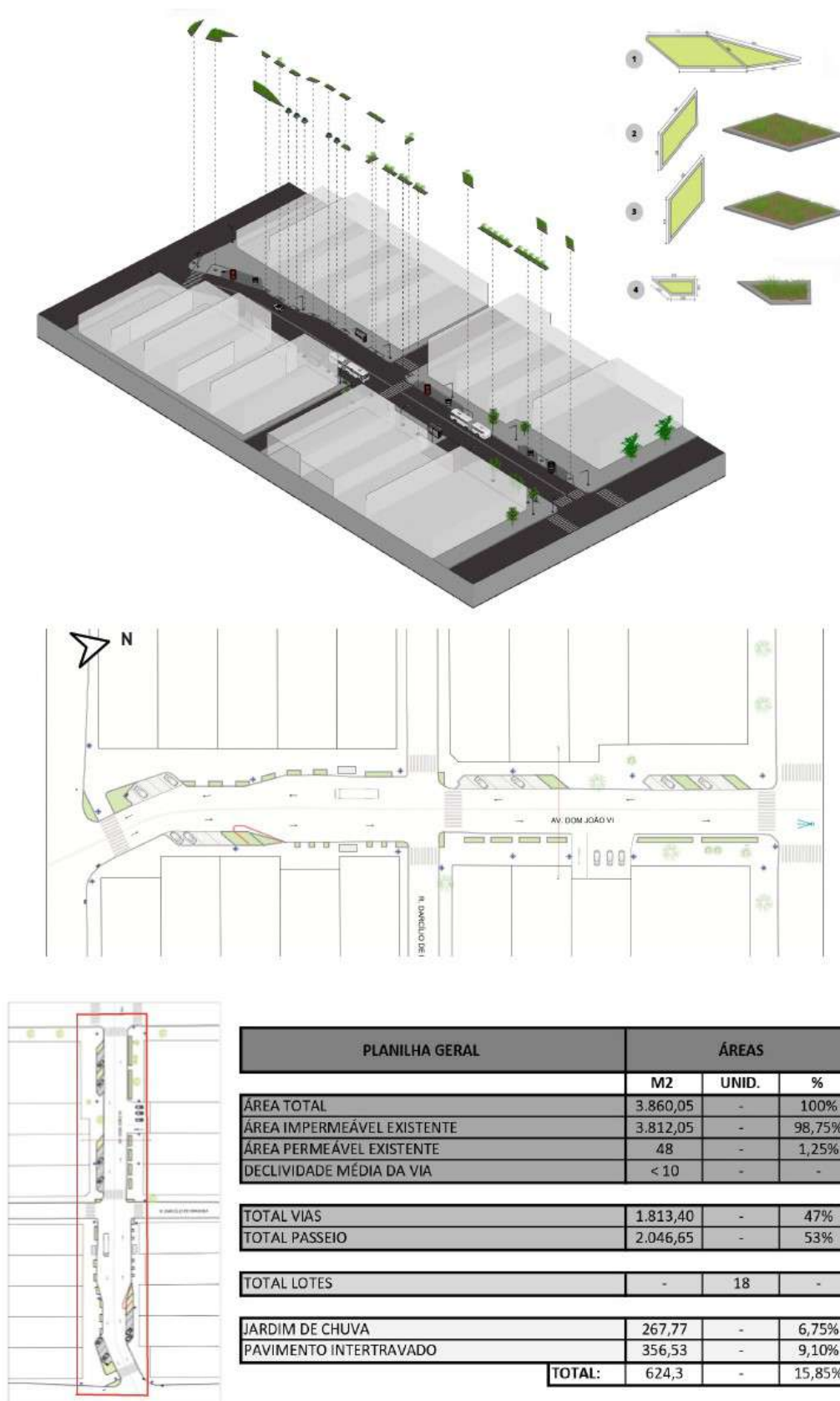
Figura 81: Prancha com desenhos, quantificação e implantação de jardins de chuva na circunstância EMPEV
