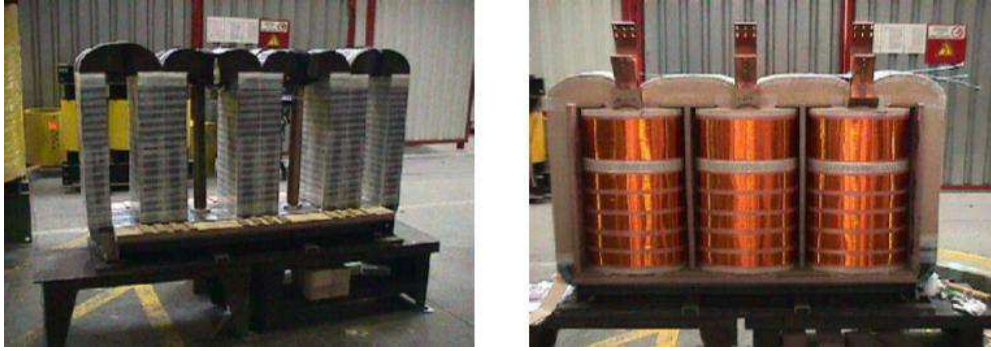
Figura 3.6: Núcleo de metal amorfo - à esquerda, disposição do núcleo com cinco pernas, e à direita, núcleo com bobinas montadas
