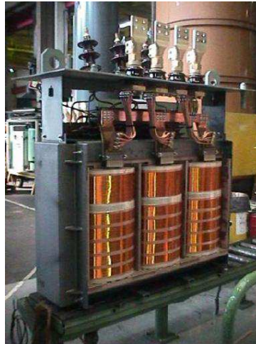
Figura 3.7: Vista interna de transformador com núcleo de metal amorfo
