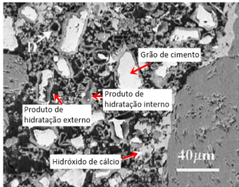
Figura 3 - Microscopia do concreto no estado endurecido
