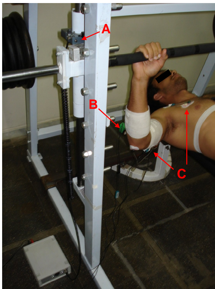
FIGURA 3: Equipamentos para aquisição de dados. A) Sensor fotoelétrico. B) Eletrogoniômetro. C) Eletrodos de superfície. Fonte: Arquivos de fotos do LAMUSC.
