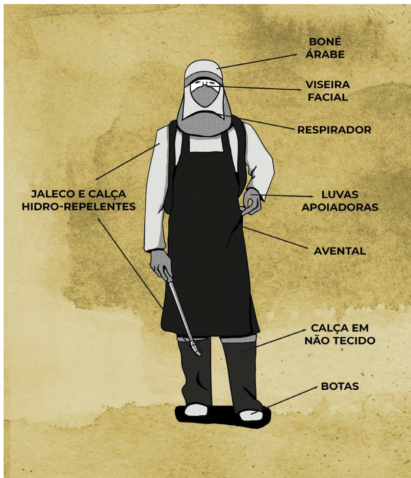
Figura 31 – Principais componentes de equipamentos de proteção individual – EPI
