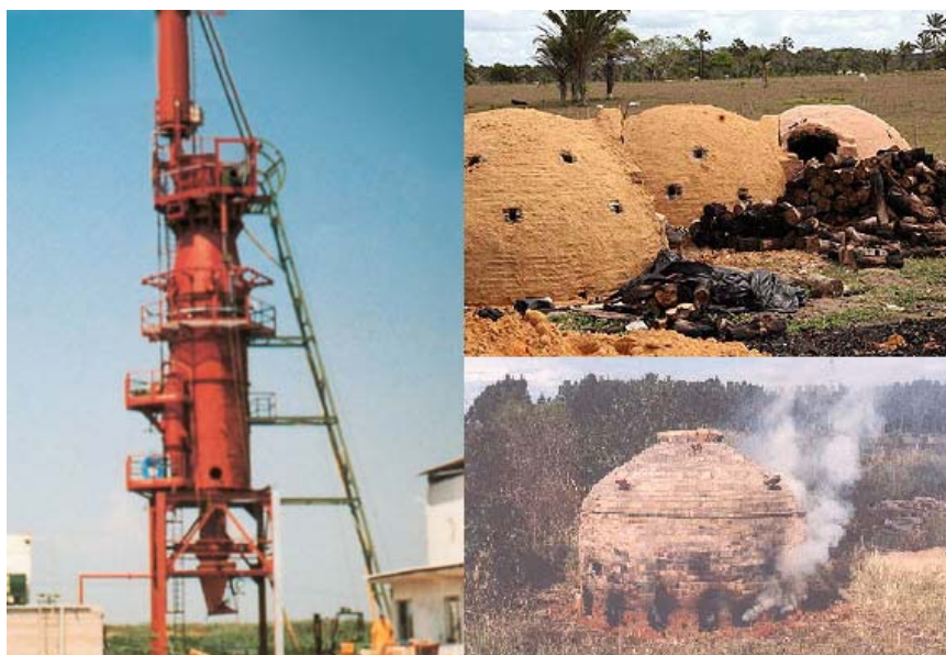
Figura 13: (a) Processo SIFIC (b) Fornos de Alvenaria Fonte: SKYNET, 2008
