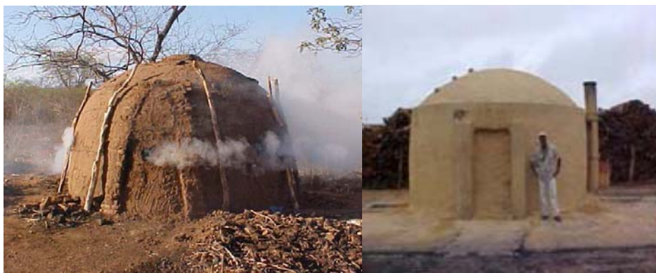
Figura 21 – Forno “rabo quente” tradicional e com chaminé. Fonte: Plantar, 2007
