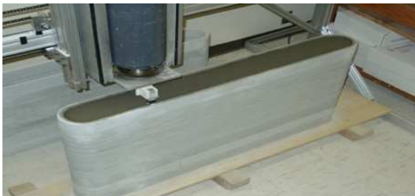
Figura 1 | Contour Crafting - Protótipo parede.
