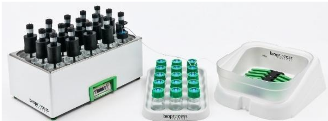
Figura 20 - Imagem do aparato experimental automatizado usado para o teste de AME (AMPTS II).
