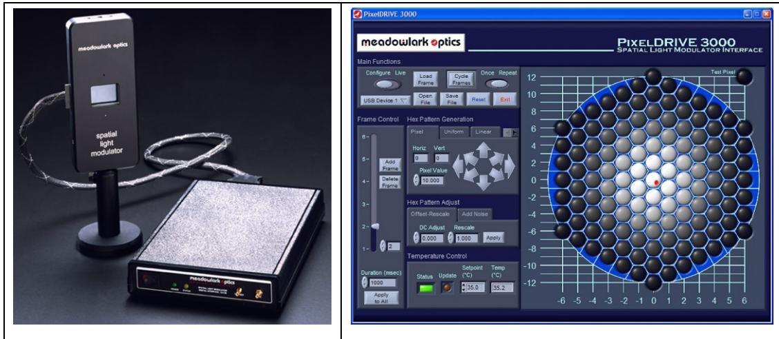
Figura 18: À esquerda está a ilustração do SLM da Meadowlark - D3128 e à direita a tela do seu programa de controle, pelo qual podemos alterar a escala de cinza de cada pixel, promovendo a variação da refração do cristal líquido para somente a componente H da luz incidente, o que provoca um atraso da componente H em relação à V (ou vice e versa) do feixe de luz que o atravessa. As operações SU(d) e o ruído de defasagem serão implementados por este SLM como explicado na Figura 14.
