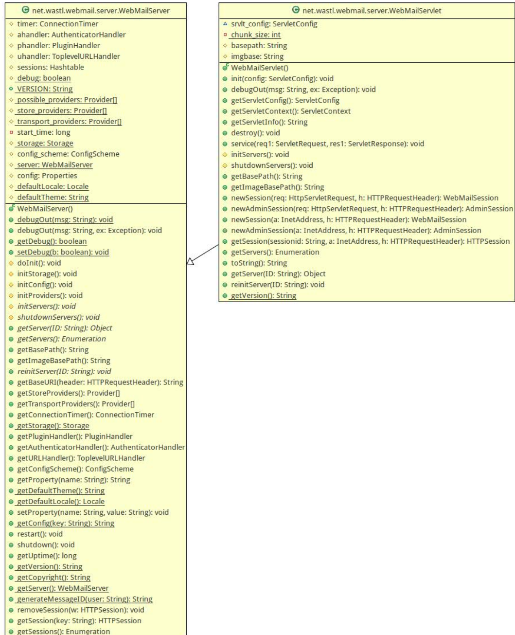
Figura 6.7. Diagrama de Classes que representa a relação Template Method \Rightarrow Feature Envy .
