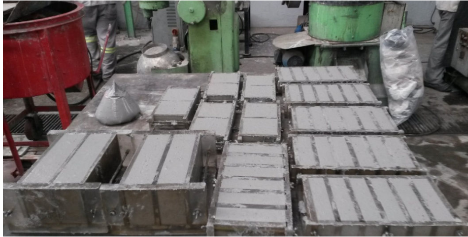
Figura 3.6 – Corpos de prova após moldagem, durante cura ao ar por 24h
