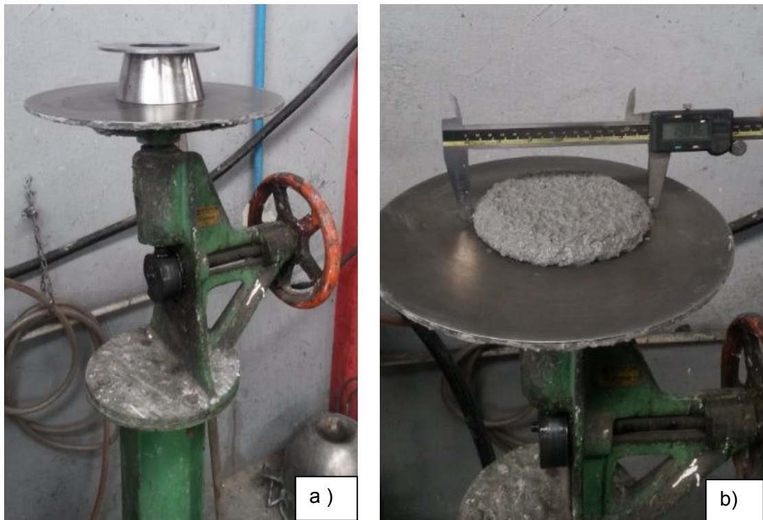
Figura 3.7 – Ilustração a) equipamento utilizado, b) medida do diâmetro máximo após 15 batidas
