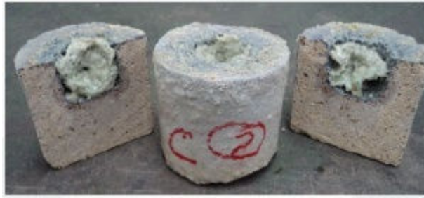
Figura 3.15 – Teste realizado para medir infiltração de álcalis Fonte: Magnesita Refratários S.A..
