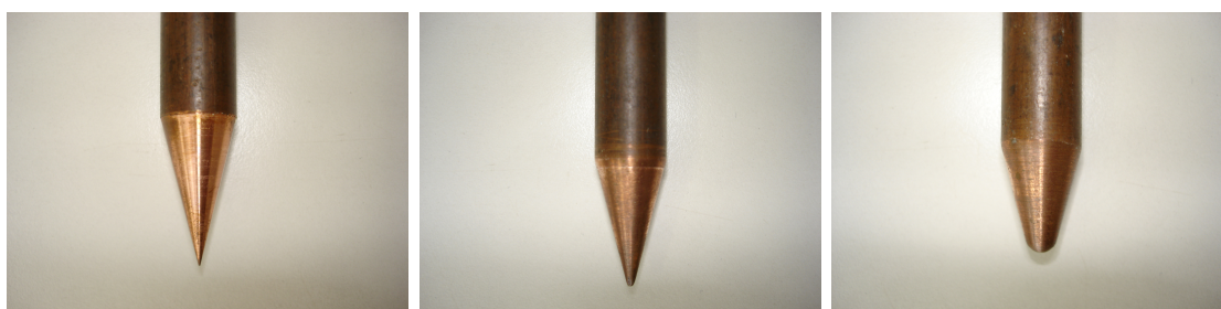
Figura 3.2: Eletrodos de raios r_1 , r_2 e r_3 , utilizados nos arranjos ponta-plano
