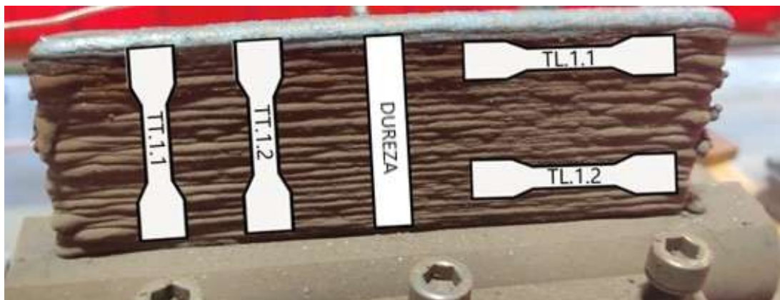
Figura 5. Representação das regiões onde os corpos de prova foram removidos.
