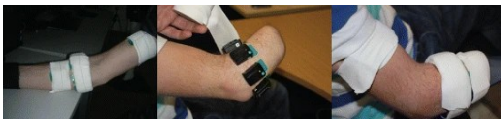
Figura 34 – Disposição dos eletrodos utilizados nos bancos de dados DB2, DB3 e DB7 do NINAPRO durante a coleta de sinais de sEMG
