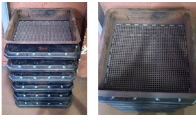
Figura 4.2: Pot-Grate , Peneiras para pelota crua da Samarco Mineração S.A.
