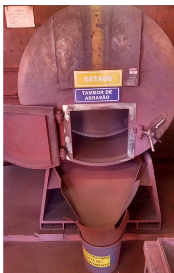
Figura 4.8: Pot-Grate , Tambor de abrasão (66TA06) da Samarco Mineração S.A.
