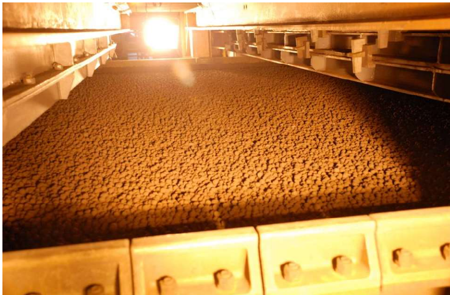
Figura 4.10: Vista superficial do leito de pelotas cruas na entrada do forno tipo grelha móvel utilizada para captura de imagens pelo granulômetro, medidor de granulometria das pelotas cruas.
