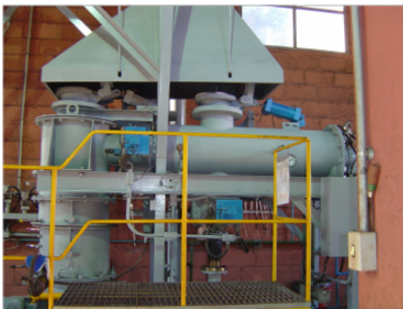
Figura 4.7: Pot-Grate , forno estático simulador do processo de queima do forno de grelha móvel da Samarco Mineração S.A.
