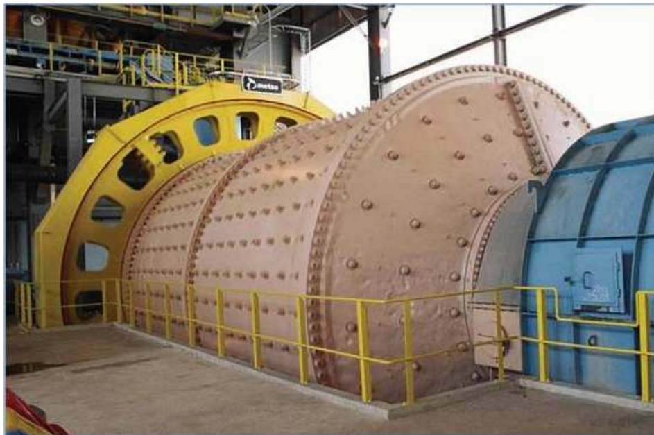
Figura 4.4 - Moinho de Bolas instalado na Mina de Cobre de Sossego, Pará (Metso, 2005).
