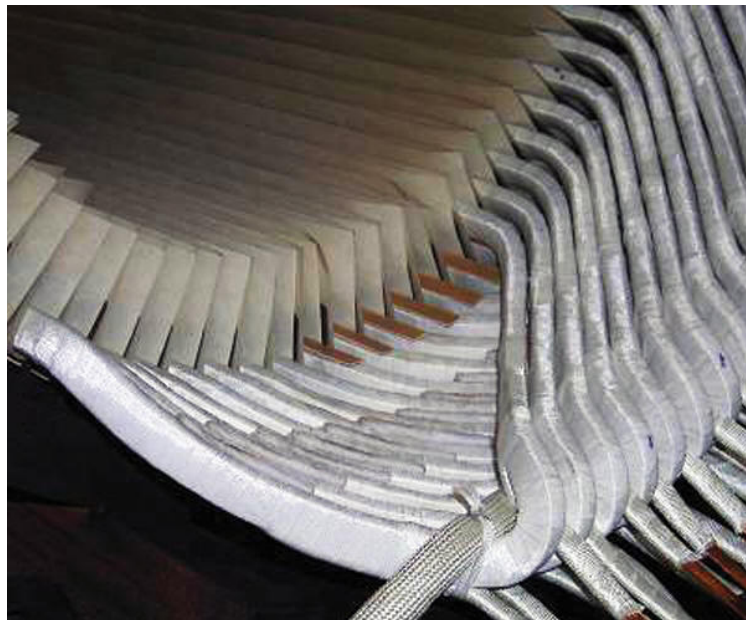
Figura 3.2 – Foto de uma bobina form montada no estator de um MIT de MT [69].
