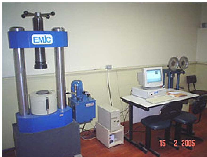
Figura 3.5 – Máquina de ensaio de compressão. Prensa Hidráulica Informatizada Elétrica Modelo PC 200 I
