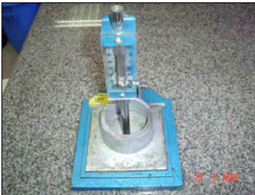
Figura 3.1 – Aparelho de Vicat. Características: Peso da sonda; (300 \pm 0,5) g; Diâmetro da sonda (10 \pm 0,05) mm; Diâmetro da agulha (1,13 + 0,01 \text{ à } -0,02) mm; Diâmetro interno do molde, Superior (70 \pm 1) mm e Inferior (80 \pm 1) mm; Altura do molde; (40 \pm 0,5) mm e Espessura do molde (8 \pm 1) mm.
