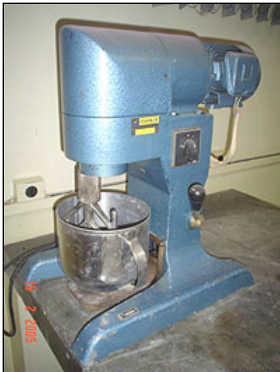
Figura 3.2 – Argamassadeira Mecânica, Elétrica para Laboratório. Capacidade: 5 litros; Duas velocidades de mistura; Componentes: Misturador mecânico, Pá de inox, Cuba de inox cap. 5 litros.
