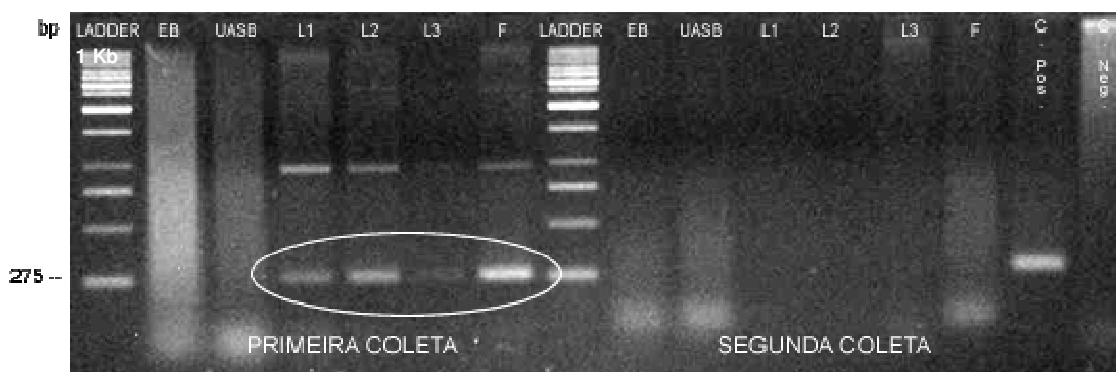
Figura 5.12 – PCR das amostras de esgoto bruto, efluente do UASB, efluentes das lagoas 1, 2, 3 e do efluente ao filtro, utilizando os primers para Salmonella spp.
