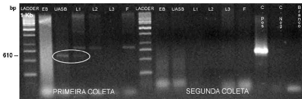
Figura 5.14 – PCR das amostras de esgoto bruto, efluente do UASB, efluentes das lagoas 1, 2, 3 e do efluente ao filtro, utilizando os primers para Shigella spp.
