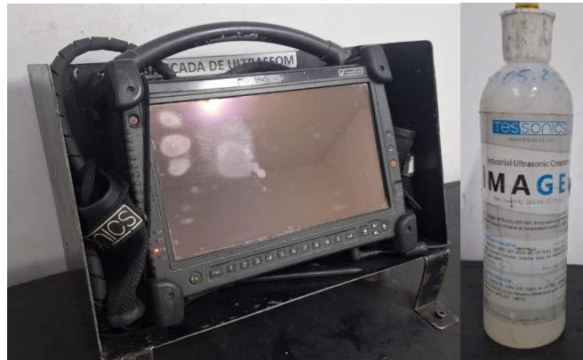
Figura 2 – Ultrassom Tessonics F1 e o Gel Acoplante (Fonte: autor)
