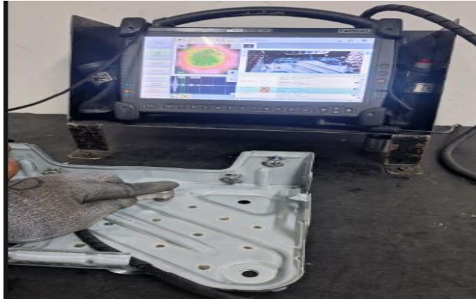
Figura 4 – Teste de ultrassom (Fonte: autor)
