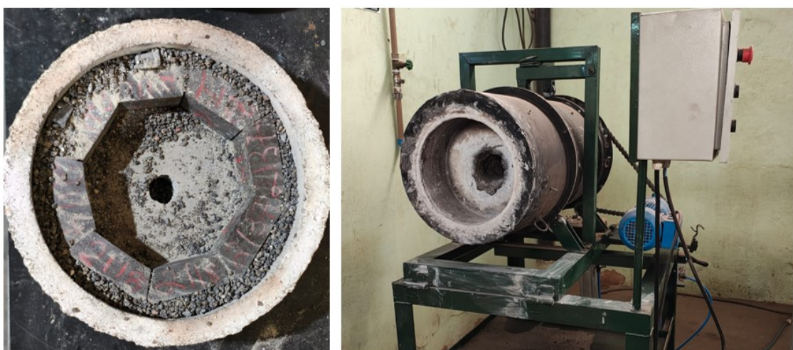
Figura 9 - À esquerda um esquema de montagem para teste de corrosão em forno rotativo e à direita uma foto do forno que realiza este tipo de ensaio.
