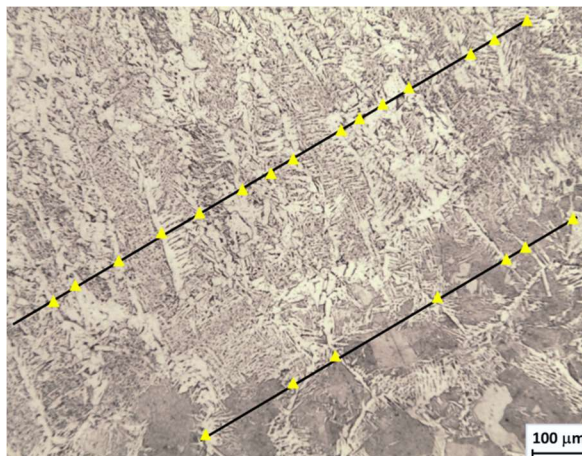
Figura 4.8 - Medições entre ferritas primárias de contorno de grão na ZF e na ZTA por método semelhante ao do intercepto linear. Amostra soldada com 800 A, 34 V e adição de arame frio com W_C/W_W=1 .
