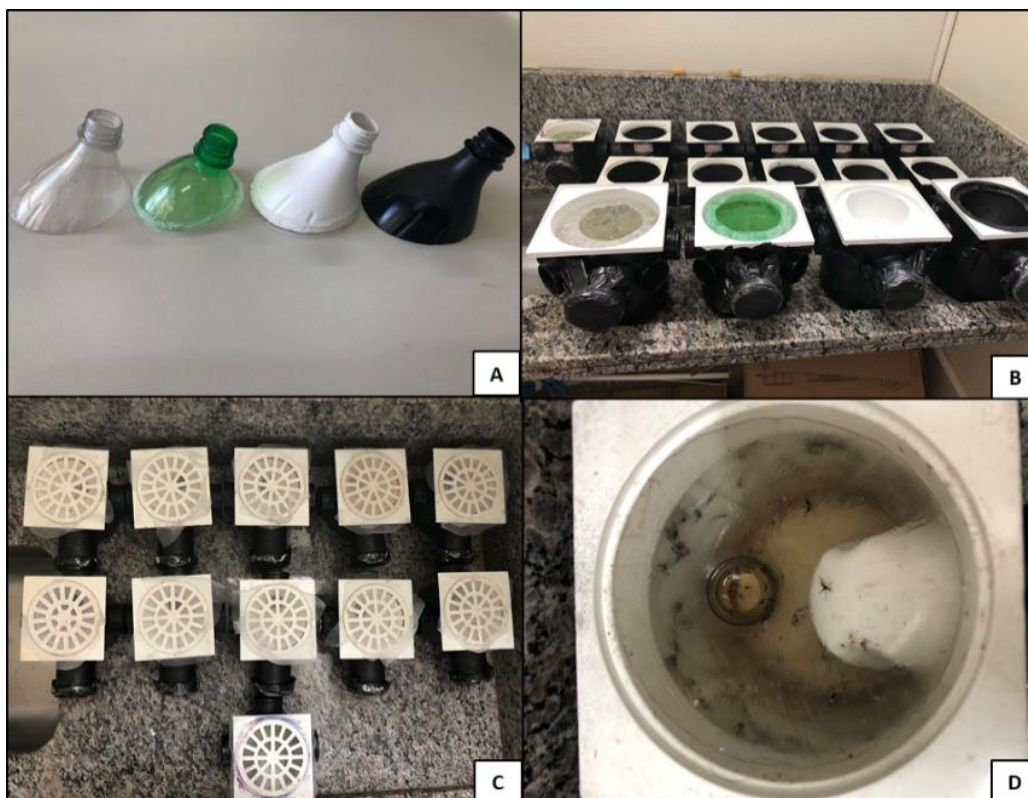
Figura 39. Teste de laboratório para avaliar a eficácia dos protótipos: (A) Protótipos (tratamentos) de colorações diferentes; (B) teste em ralos maiores (150x150x50mm); (C) teste com pets brancos em ralos menores (100x100x50mm); (D) Ralo com pet transparente visto de cima com mosquitos mortos no interior.
