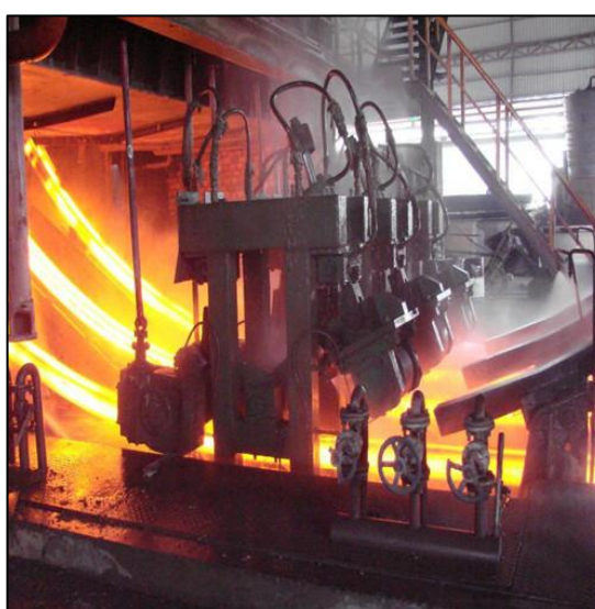
FIGURA 2.6 – Vapor de água produzido durante o resfriamento na máquina de lingotamento contínuo FONTE – Cooldo (2016) 8
