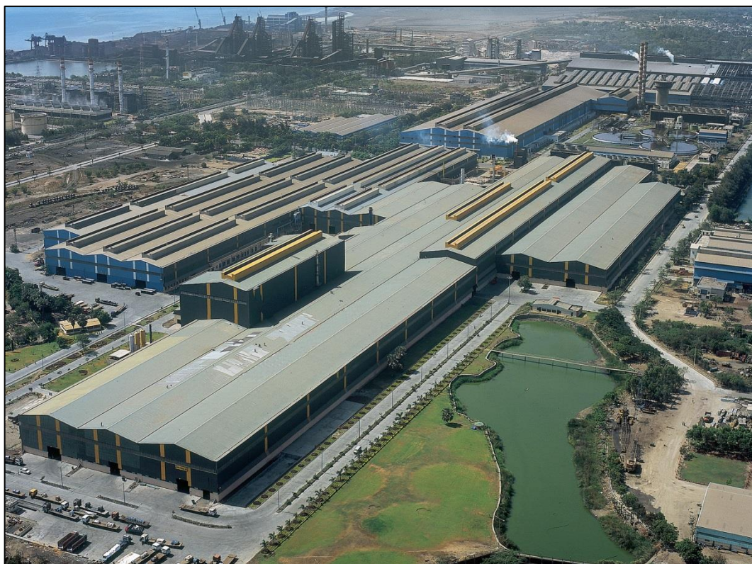
FIGURA 1.1 – Lago para armazenamento de água de chuva coletada nos galpões da laminação a frio da Essar Steel Hazira - Índia. FONTE – ESSAR STEEL (2015) 3
