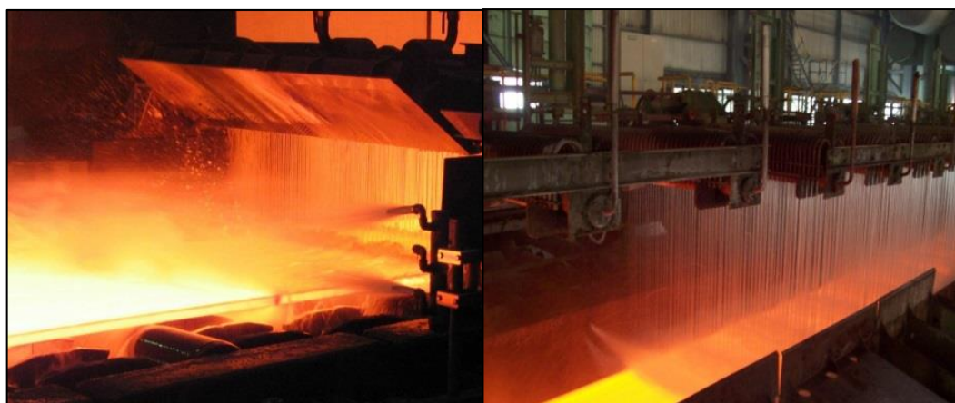
FIGURA 2.11 – Uso da água por contato direto no processo de laminação a quente. FONTE – Adaptado de Siemens (2013)
