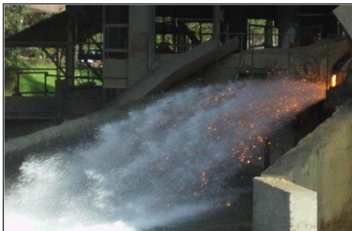
FIGURA 2.5 – Uso da água nos altos-fornos no granulador de escória FONTE – Ferroeste (2012) 7
