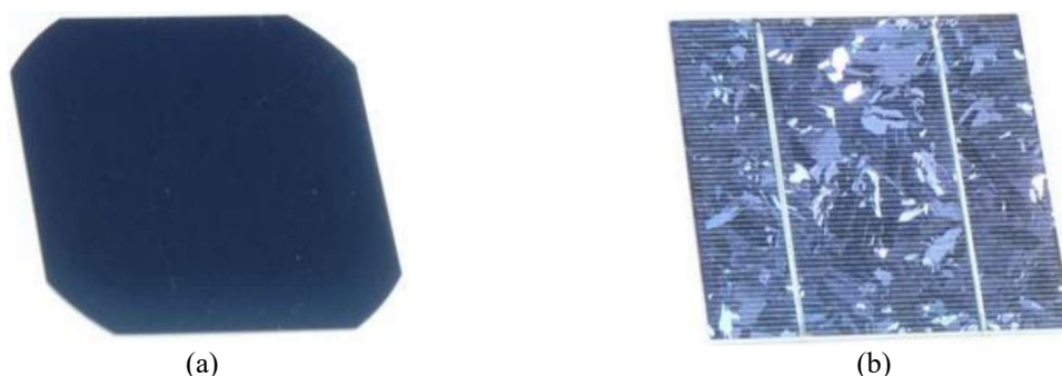
Fig. 2.3: Célula fotovoltaica de a) silício monocristalino ( m-Si ) e b) silício policristalino ( p-Si ) [25].
