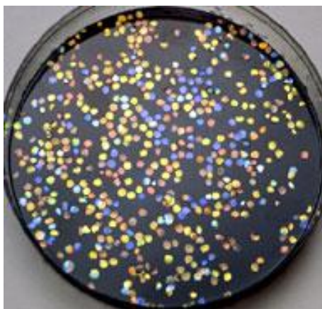
Figura 1.16. Confetes preparados a partir de filmes obtidos com NCCs. Cada cor foi preparada a partir de suspensões com diferentes concentrações de NaCl [68].
