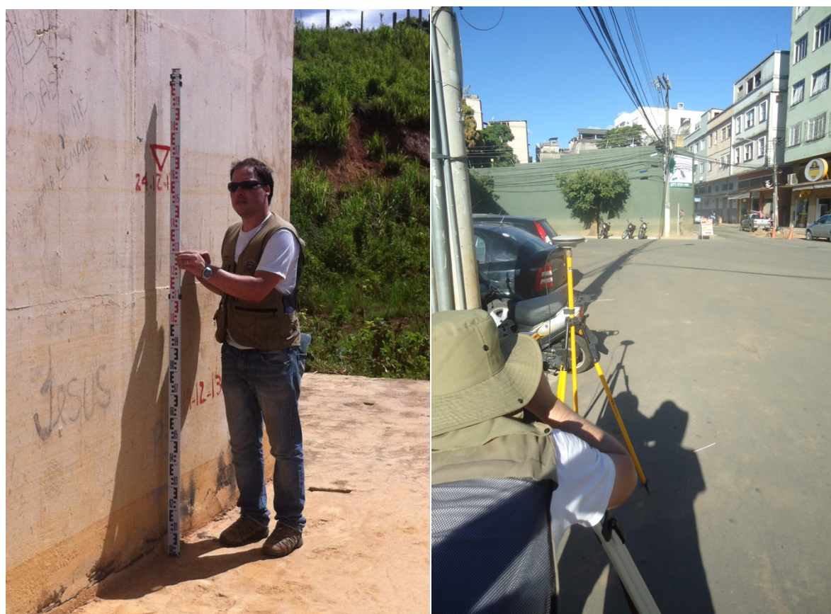
Figura 4.22 - Nivelamento da marca de cheia na seção nº 100 do rio Doce e de marca de cheia dentro da área urbana, respectivamente
