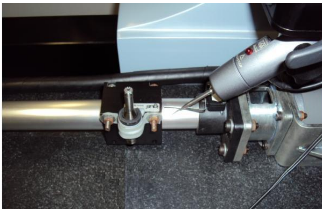
FIGURA 3.27 - Validação Metrológica do Eixo Vertical
