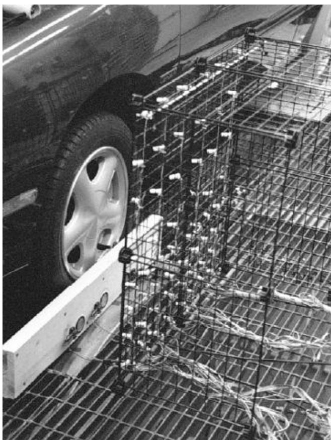
FIGURA 2.30 Arranjo de Múltiplos Sensores em Wang et al 1995
