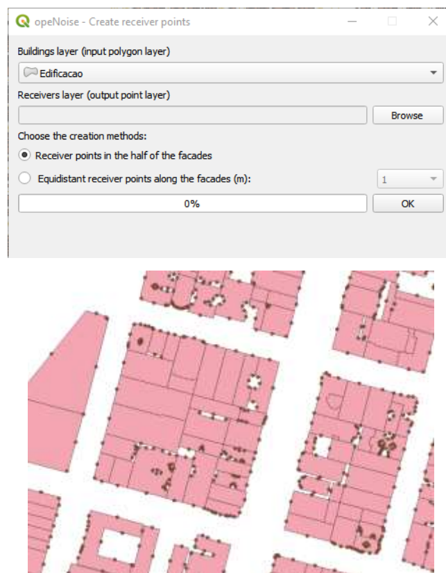
Figura 38 - Uso do plugin OpenNoise - identificação dos pontos para mensuração. Fonte: a autor.
