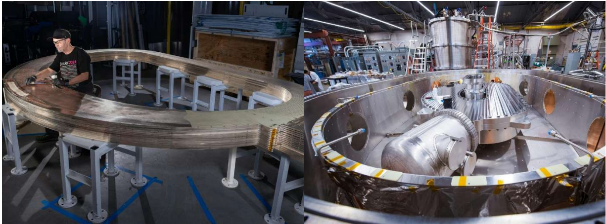
(a) (b) Figura 6: (a) Registro da construção da bobina toroidal desenvolvida pela Commonwealth Fusion Systems (CFS) e (b) Registro do laboratório de testes [42].
