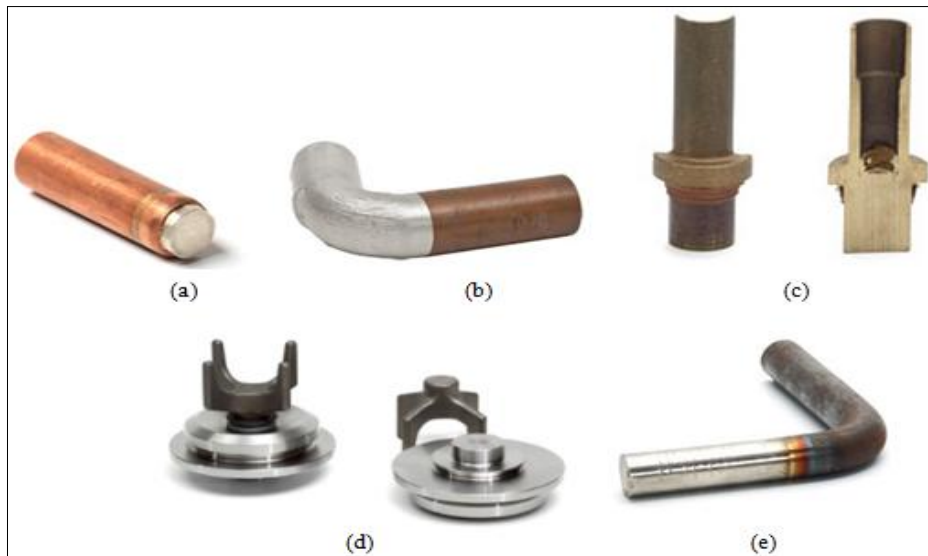
FIGURA 2.15. – Soldas por fricção - (a) Diodo elétrico de prata e cobre; (b) Componente eletrônico industrial de cobre e alumínio; (c) Tudo de bronze soldado a base sólida; (d) Válvulas forjadas soldas por fricção; (e) Solda de aço inoxidável com aço carbono.
