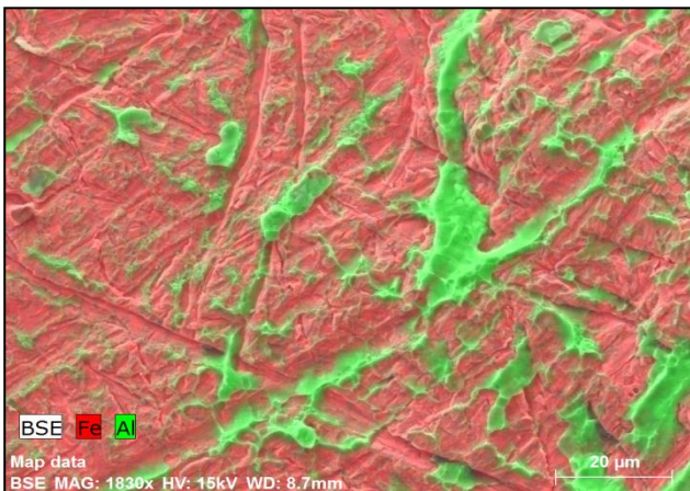
FIGURA 4.19. – Superfície de fratura do aço. Soldas sem preaquecimento.
