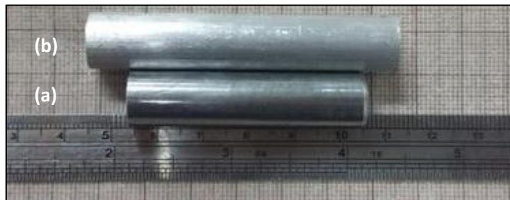
FIGURA 3.10. – Ajuste nos corpos de prova- (a) aço: 50mm; (b) alumínio: 65 mm.
