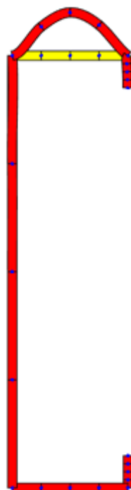
Figura 48 – Modo de flambagem – flambagem local – momento fletor em torno do eixo de simetria – Ue 300 x 85 x 25 x 6,30.
