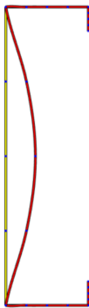
Figura 39 – Modo de flambagem – flambagem local – momento fletor em torno do eixo perpendicular ao de simetria – Ue 300 x 85 x 25 x 2,00.
