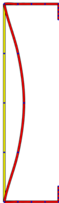
Figura 79 – Modo de flambagem – flambagem local – momento fletor em torno do eixo perpendicular ao de simetria – Ue 300 x 85 x 25 x 3,00.
