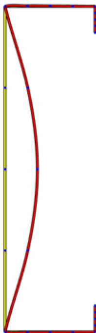
Figura 37 – Modo de flambagem – flambagem local – força axial de compressão – Ue 300 x 85 x 25 x 2,00.
