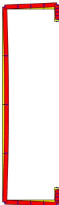
Figura 45 – Modo de flambagem – flambagem distorcional – força axial de compressão – Ue 300 x 85 x 25 x 6,30.
