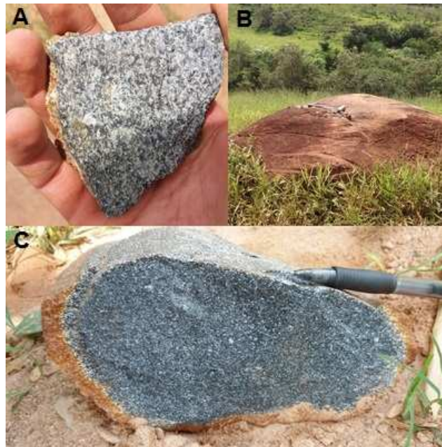
Figura 3 - (A) Amostra de rocha anfibolítica com textura granoblástica; (B) Afloramento de anfibolito; (C) Rocha anfibolítica com granulação fina.
