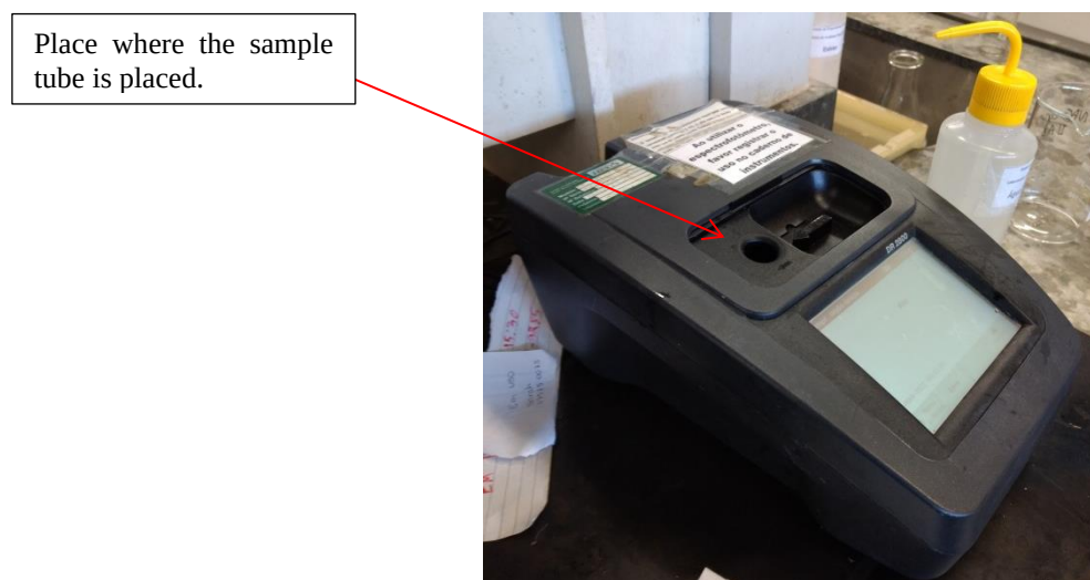
Figure 3. 7: Spectrophotometer of the Laboratório Prof. José Marcelino de Oliveira, DESA, UFMG.
