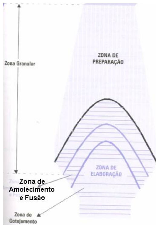
Figura 3.28 – Esquema das zonas de preparação e elaboração de um alto-forno, (JACOMINO et al., 2002).
