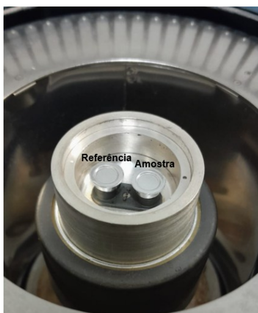
Figura 7 - Localização do cadinho de referência e da amostra dentro do calorímetro.
