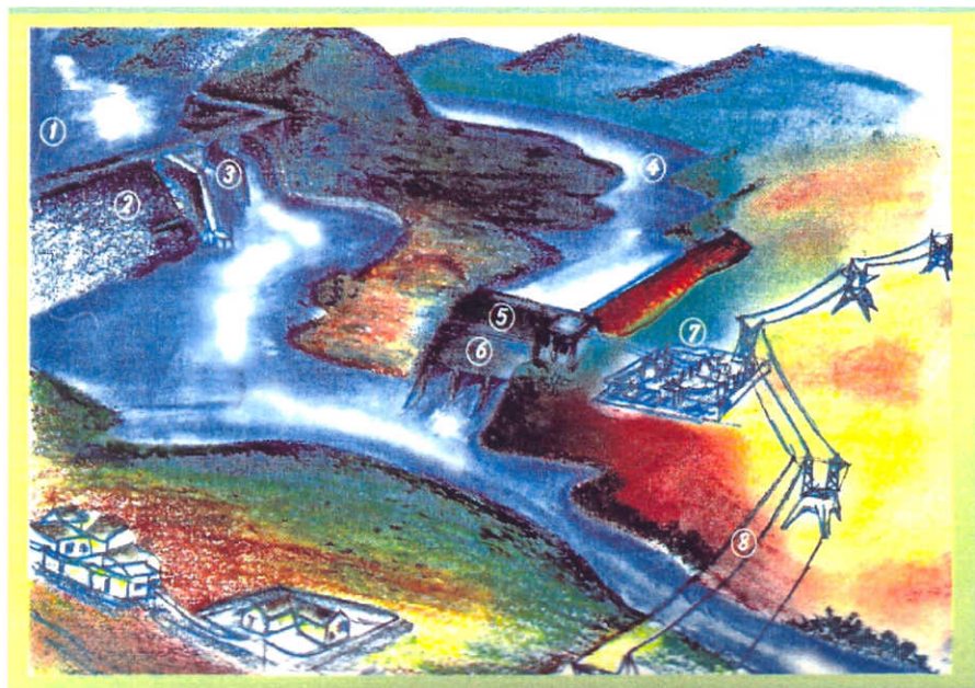
Figura 7: Esquema dos componentes da Usina Hidrelétrica de Aimorés. Fonte: CEMIG, 2004.
