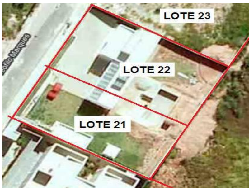
Figura 46: Detalhe do aterro no fundo dos lotes 21 e 22, invadindo o terreno vizinho dos fundos, para nivelamento do terreno
