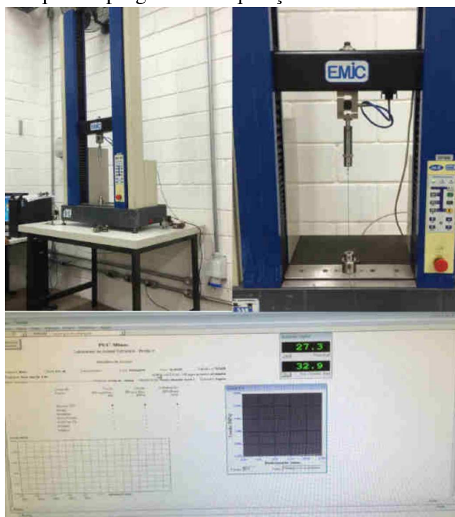
Figura 26 – Máquina e programa de aquisição de dados do ensaio de tração.
