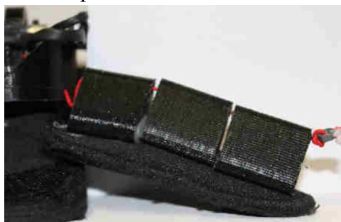
Figura 25 – Montagem dos componentes do mecanismos de atuação do módulo mão.
