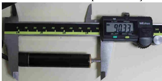
Figura 22 – Motor EC16 acoplado a redução GP16A.
