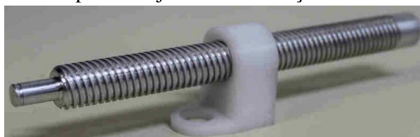
Figura 63 – Conjunto fuso e porca da junta de translação do atuador do módulo cotovelo.
