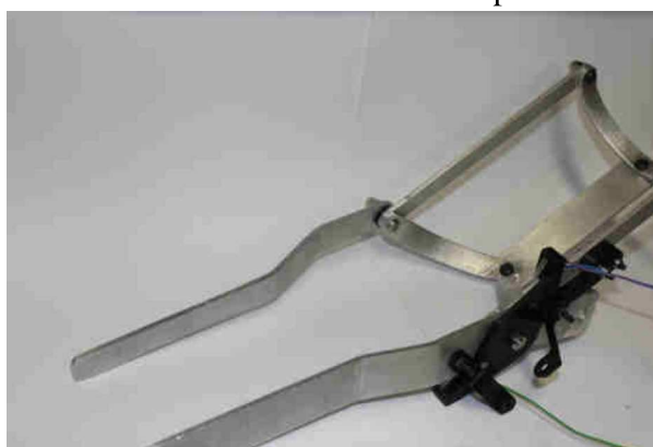
Figura 44 – Estrutura em alumínio com suportes dos sensores.
