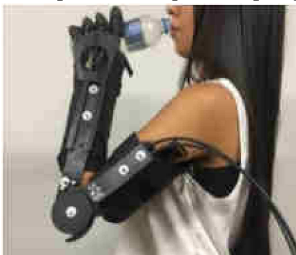
Figura 16 – Órtese desenvolvida pelo LabBio para recuperação de indivíduos pós AVE.
