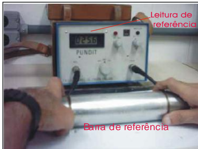
FIGURA 22 – Calibração do equipamento do ultrassom Fotos: autora
