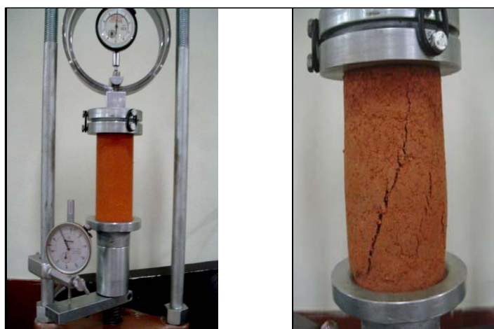
FIGURA 20 – Visão geral do aparatus (a) e detalhe da superfície de ruptura do corpo de prova (b)
